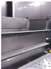
浅槽時（前面カサ取り外し時） 槽深さ 650mm
